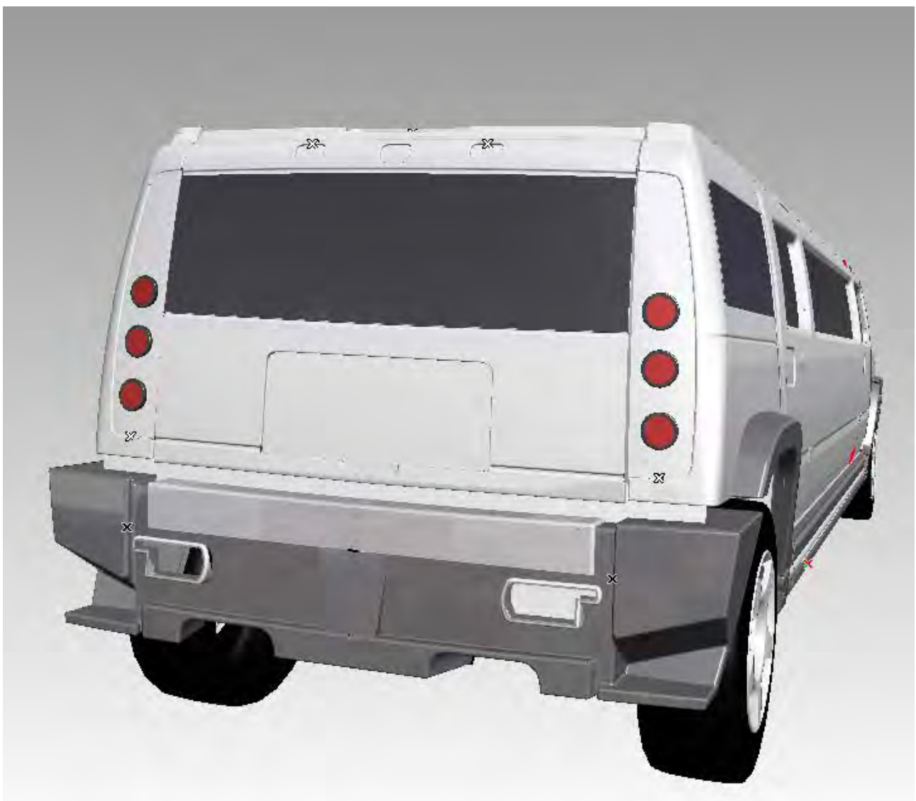
Fig 7.13 b fianco della limousine. Il parafrango laterale ora circonda la protezione laterale dell'h2 originale.
