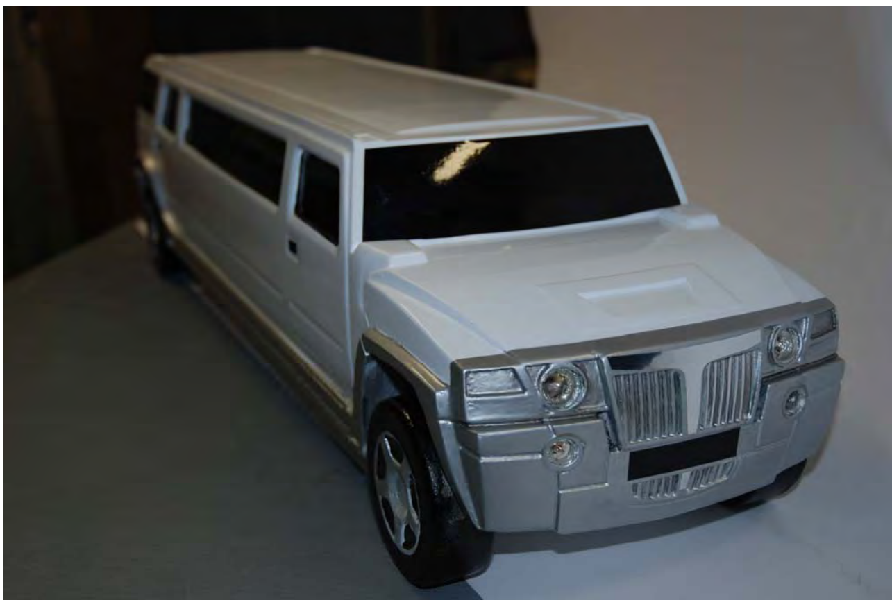
Fig 8.3 fronte del modello. Si notano le cromature realizzate con apposito materiale adesivo, e i fanali realizzati in vetro.
