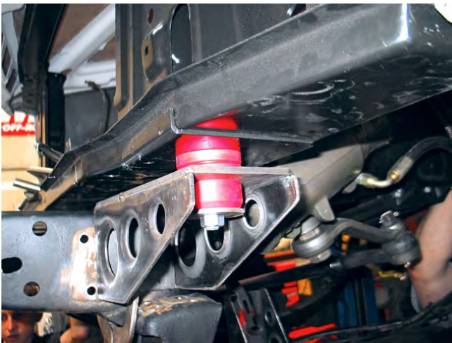
Fig 5.1 e 5.1b: particolari di attacchi di una carrozzeria ad un telaio a longheroni. I componenti rossi sono tasselli elastici di materiale gommoso.
