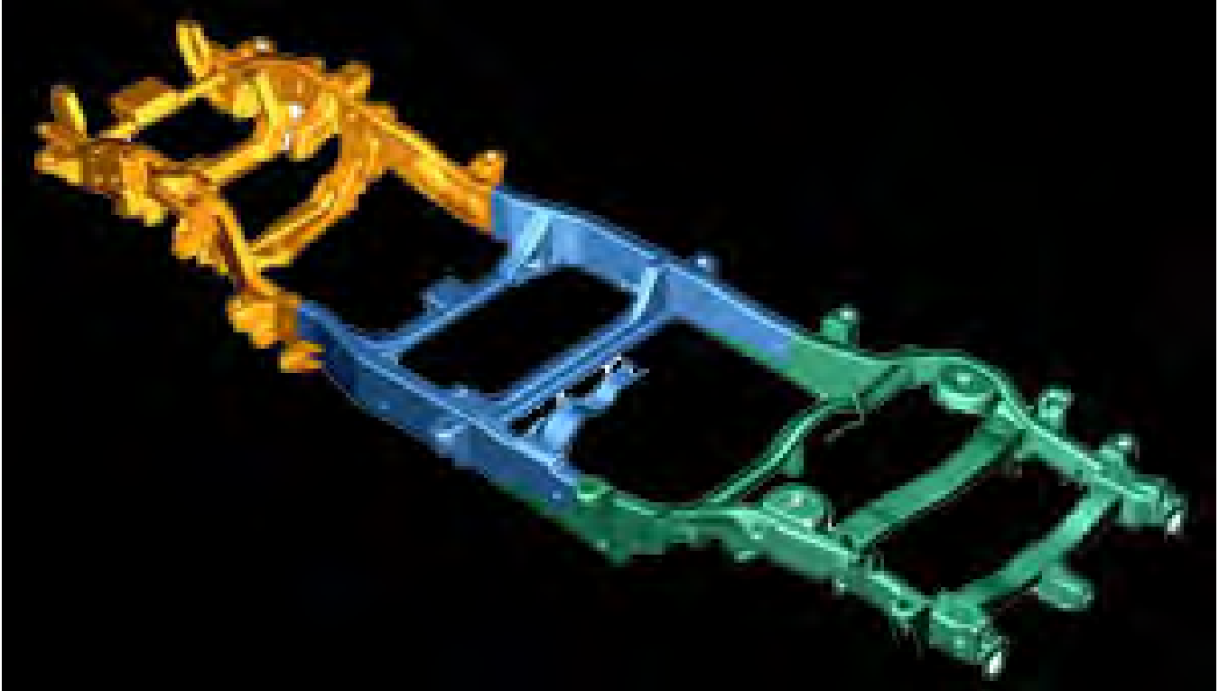
Fig 4.6: telaio a longheroni dell'hummer h2. Le tre parti che lo compongono sono state colorate di 3 diversi colori
