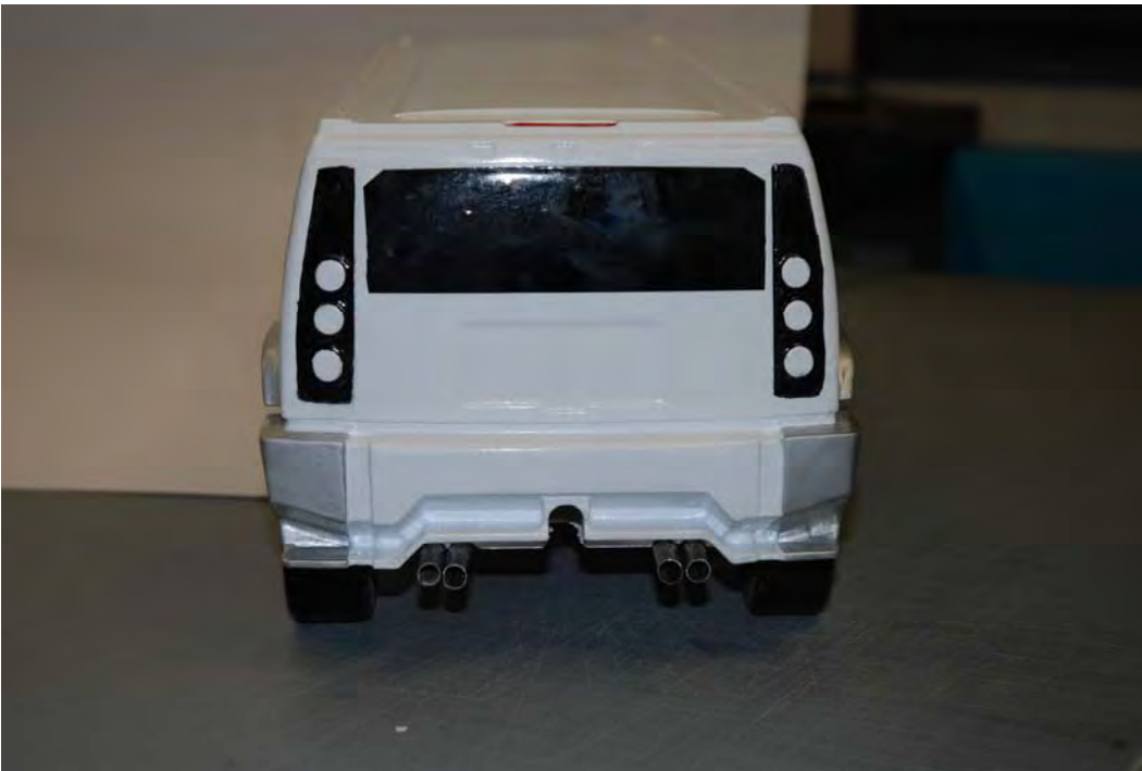
Fig 8.3 Retro del modello in poliuretano. Sono stati inseriti gli scarichi in metallo
