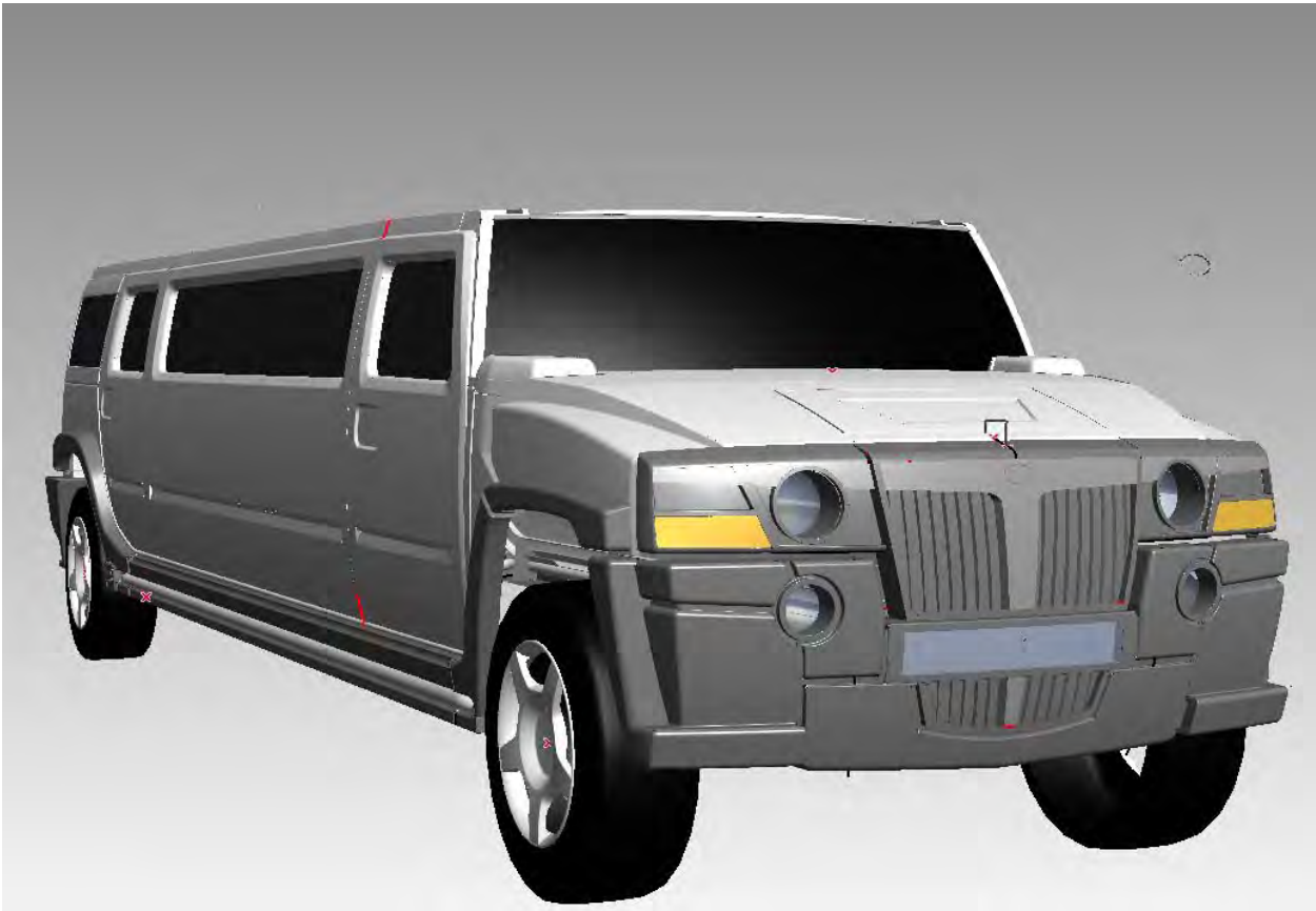
Fig 7.13 Primo modello realizzato. Sono state cambiate le frecce anteriori, ridisegnati i parafranghi, paraurti anteriore ed è stata aggiunta una mascherina stile “intercar”
