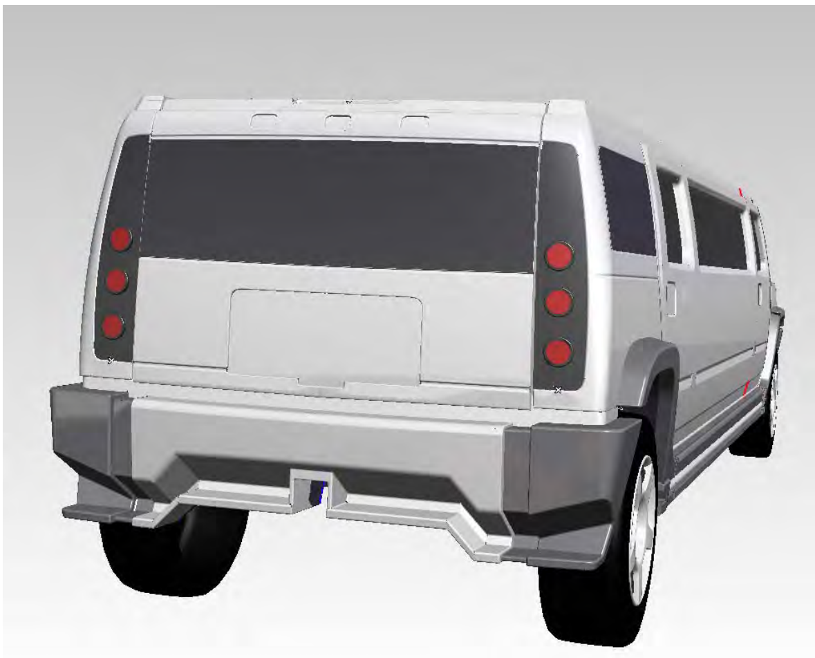
Fig 7.15 versione definitiva dell'Hummer h2. Il frontale ricorda di più il veicolo originale, anche se restano gli elementi distintivi dell'intercar. Anche il paraurti posteriore è stato "alleggerito" dandogli uno stile più sportivo. Per il gancio di traino è stato ricavato un foro nella parte centrale del paraurti
