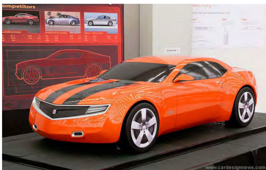
Fig. 1b prototipo concettuale di una automobile: mostra esattamente come sarà la forma esterna del veicolo, ma è privo di motore e organi funzionali.
