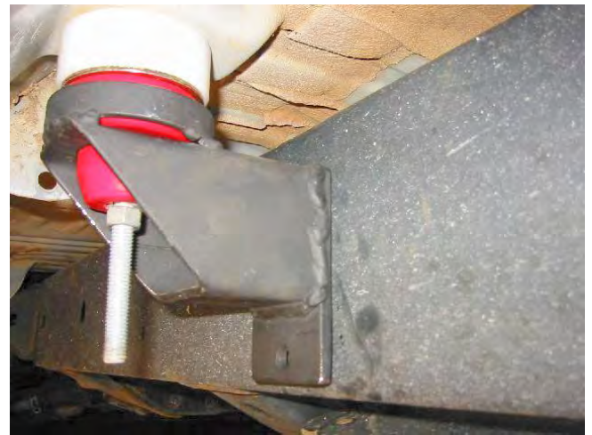
Fig 5.1 e 5.1b: particolari di attacchi di una carrozzeria ad un telaio a longheroni. I componenti rossi sono tasselli elastici di materiale gommoso.
