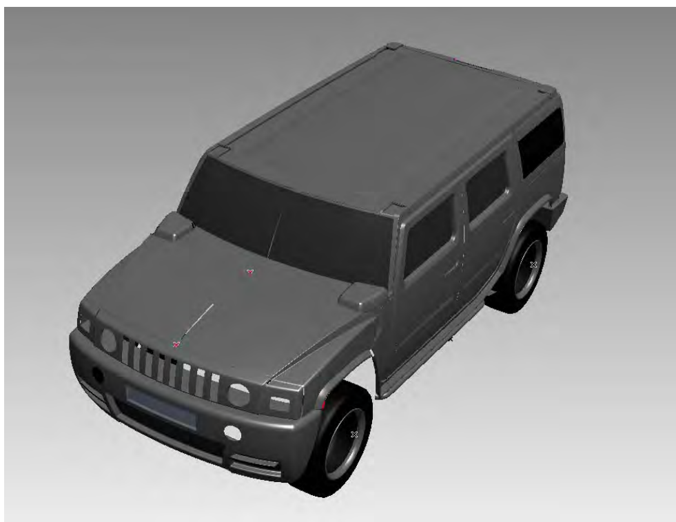
Fig 2.2 Modello 3d di un veicolo Hummer h2: sono state create tutte le superfici, e se ne comprende l'andamento
