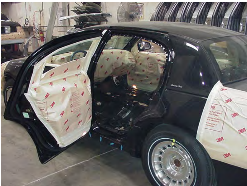
Fig 4.2 nel particolare si vedono coperture di protezione applicate a vetri e cruscotto
